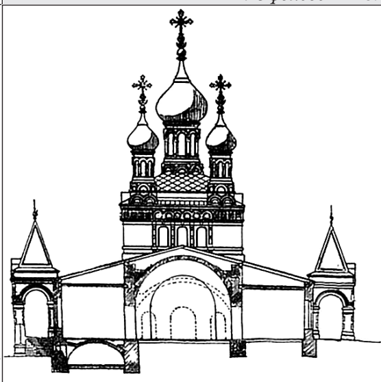
Проект расширения Мотовилихинской Свято-Троицкой церкви (1901 год). Фасад. Разрез по А, В. Разрез по С, Д. Из фондов ГАПО.
